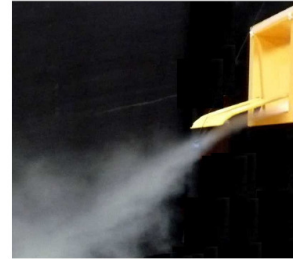
Luftleitung in den Tierbereich
