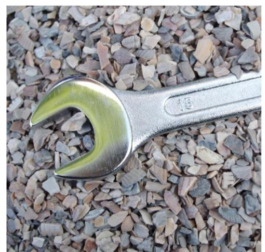
Abb. 57: Muschelschrot – der Maulschlüssel dient als Größenorientierung.
