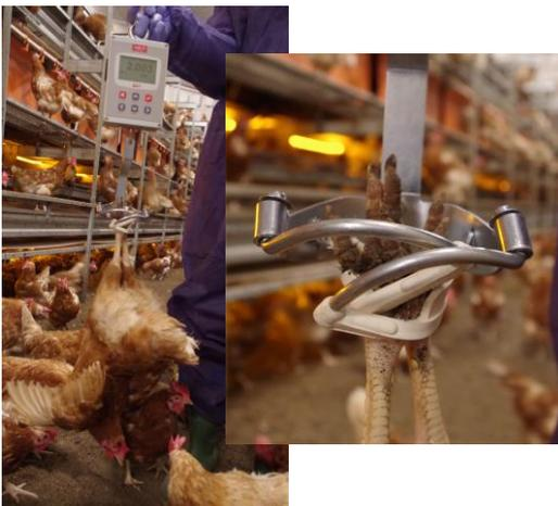
Abb. 47: VEIT-Hängewaage und Klemmhaken mit Gummi. Diese Waage wurde im Projekt verwendet. Die Hennen werden für kurze Zeit kopf- über mit den Füßen im Klemmhaken fixiert. Die Tiere können ruhig und zügig gewogen werden.
